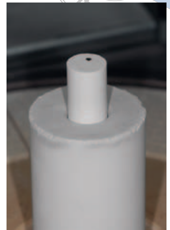
Abb. 11 Vor dem Pressprozess, die Muffel mit eingesetztem Pressstempel.
