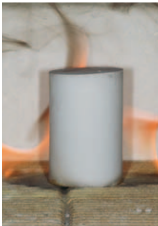
Abb. 8 Die Muffel während des Ausbrennvorgangs im Ofen.
