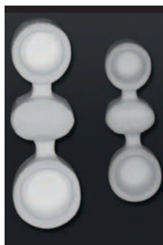
Abb. 7 Zirkoniumdioxidbrücken, links im Weißzustand, rechts dichtgesintert.
