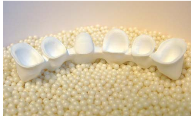
Abb. 2: Positionieren zum Sintern einer ZrO 2 -Brücke auf nt-pearls.
