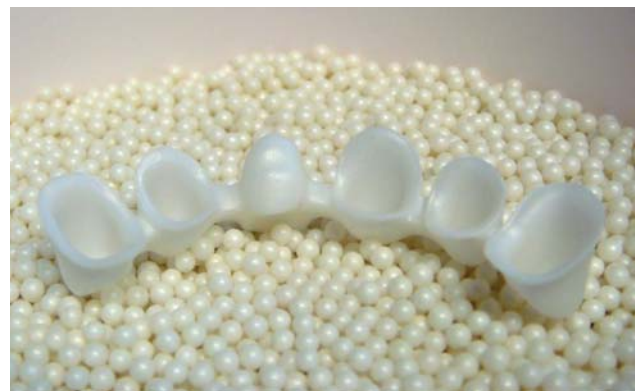
Abb. 4: Objekt nach dem Sintern auf nt-pearls.
