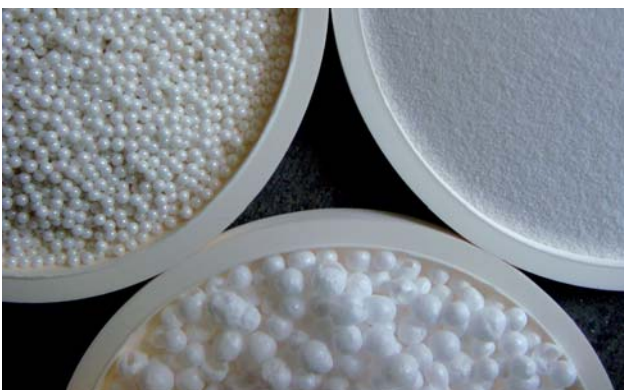
Abb. 7: Unterschiedliche Granulatqualitäten – nicht jede Partikelgröße eignet sich als Sinterabstützung.
