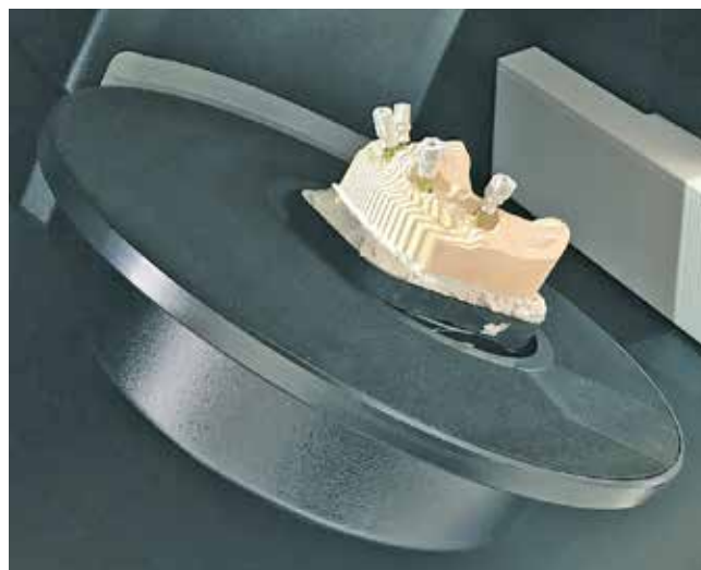
Abb. 5: Streifenlicht-Scan des Unterkiefermodells.
